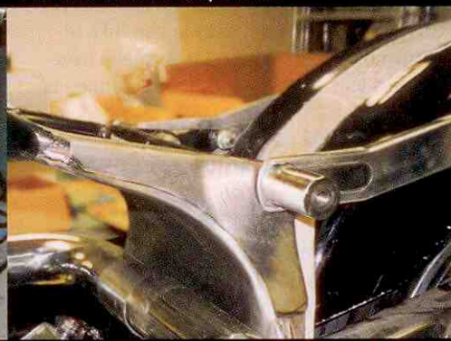
1mm plaat ronding onder zadel in lijn met onderkant benzinetank
