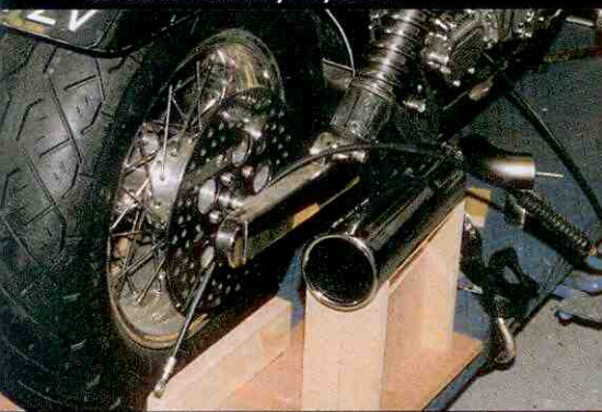
Met behulp van houten steunen worden de uitlaten 'uitgelijnd'
