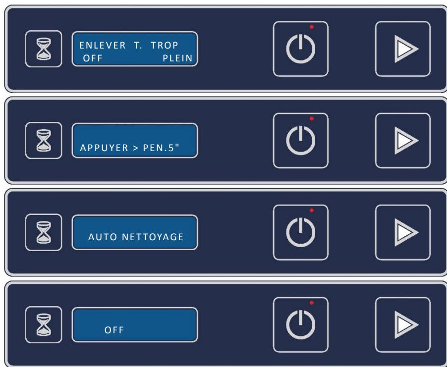
Il est possible de programmer la vidange obligatoire de la cuve et du surchauffeur à une cadence pouvant aller de 1 à 50 cycles. Lorsque l'avertissement s'affiche « FORCED DRAIN », la lave-batteries se bloque et reste dans cette condition jusqu'à la vidange complète de la cuve.
