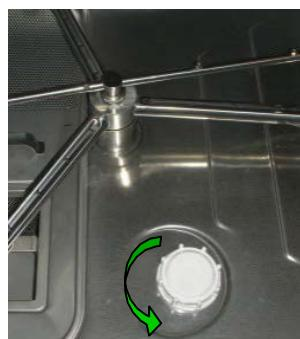
Zorg ervoor dat het zout niet wordt gemorst en de voorgeschreven hoeveelheid niet overschrijdt. Na het toevoegen van het zout, maak de afsluiting schoon, sluit de dop goed, verwijder eventuele zoutresiduen, verwijder de overloop en spoel de tank af.
