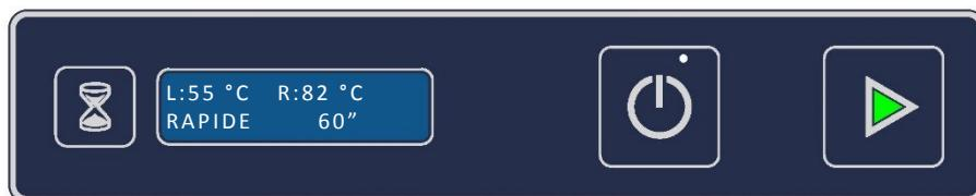
Une fois atteinte la température programmée, termostop actif, le triangle lumineux (26) passe au vert il est possible de lancer le cycle de lavage en appuyant sur la touche « démarrage cycle » (24).
