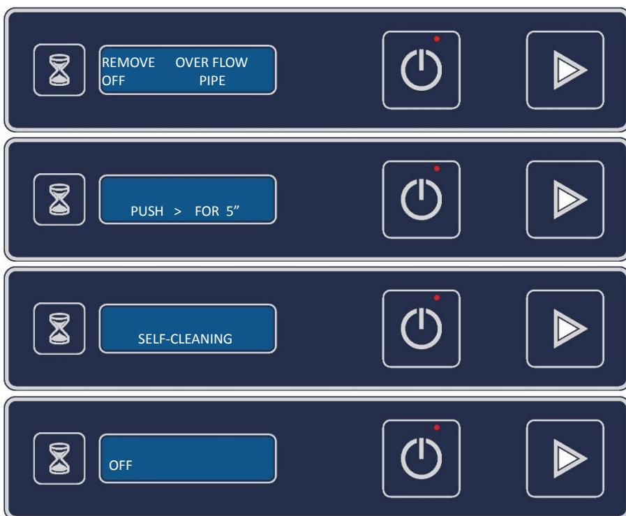
Het is mogelijk om een verplichte tank- en ketelafvoer in te stellen met intervallen van 1 tot 50 cycli. Wanneer de melding verschijnt, stopt de wasmachine en blijft in deze toestand totdat de tank helemaal leeg is.
