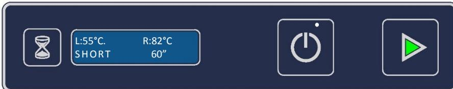
Wanneer de ingestelde temperatuur bereikt is, met thermostop actief, wordt de lichtgevende driehoek (26) groen en kan de wasbeurt worden gestart met de "startknop" (24).
