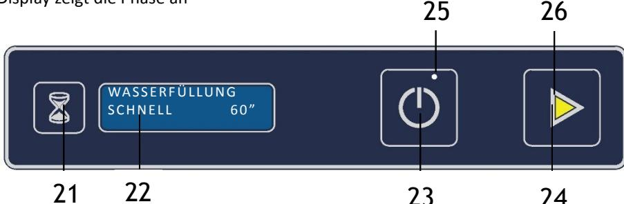
Nach erfolgtem Wasserzulauf schaltet sich die Heizung ein, am Display werden die Tank- und Boilertemperaturen angezeigt.
