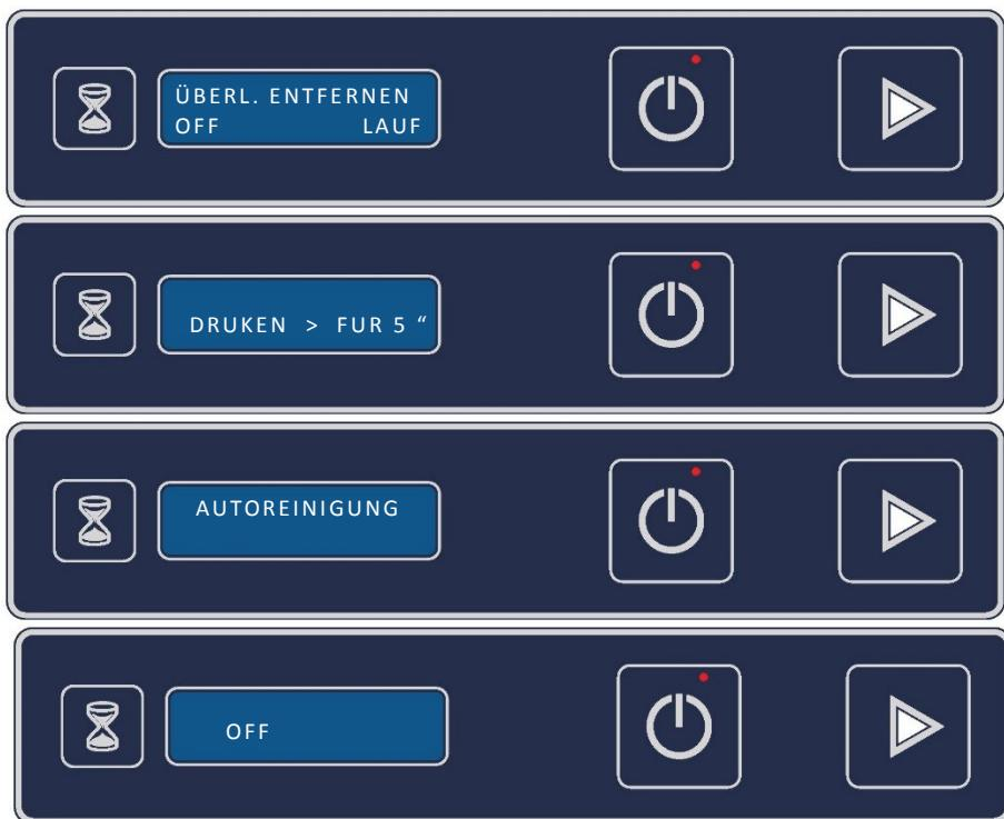
Es ist möglich, den Zwangsablauf von Tank und Boiler in regelmäßigen Abständen auszuführen, die von 1 bis 50 Spülgängen einstellbar sind. Sobald die Meldung erscheint „GEZWUNG ABFLUSS“, hält die Gerätespülmaschine an und bleibt in diesem Zustand, bis der Tank vollständig geleert ist.
