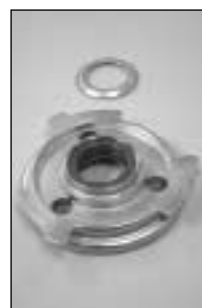
7) De koppelbus en de bovenpakking zijn gedemonteerd
