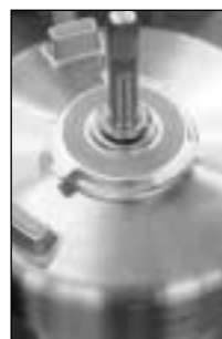
10) Vervang de bovenpakking en plaats deze op de schuine kant
